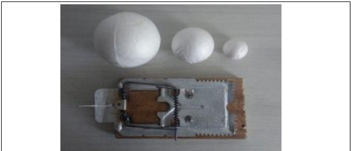
Figura 16 – Adaptação de uma ratoeira para uma catapulta de lançamento de projéteis
