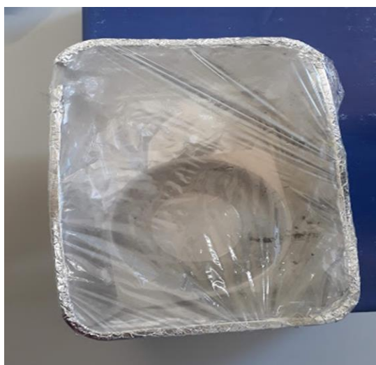
Figura 12 — Após a lâmpada ser desligada, a água evaporada condensou no plástico filme
