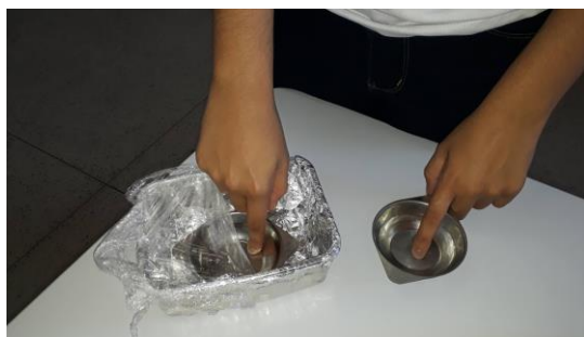
Figura 12 — Após a lâmpada ser desligada, a água evaporada condensou no plástico filme
