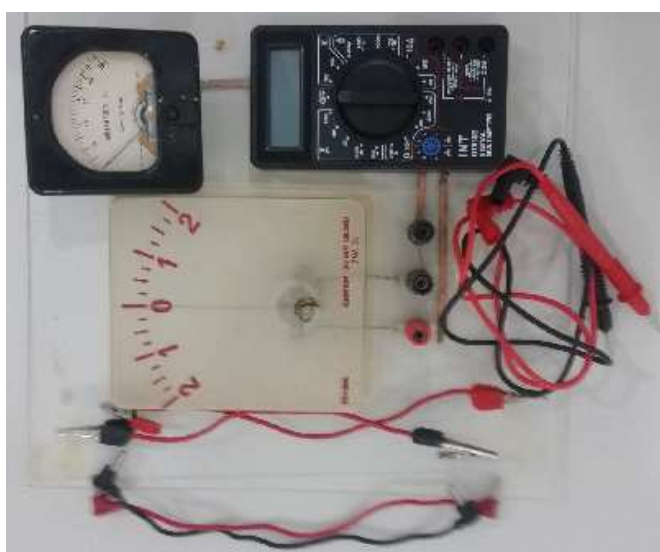
Figura 6A - Amperímetros e fios para conexão utilizados na atividade experimental 2.
