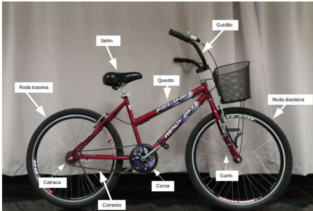
Figura 2.1: Imagem contendo separadamente todos os nomes associados à cada uma das partes de uma bicicleta.
