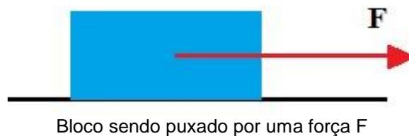
Se o coeficiente de Atrito entre o bloco e o plano vale 0,20, e a aceleração da gravidade,  $10\text{m/s}^2$ , então o módulo da força **F**, em Newtons, vale:
