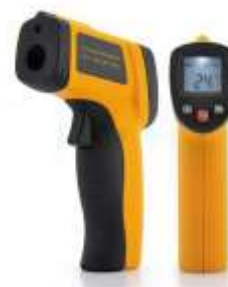
Pirômetro utilizado na visita para medição de temperaturas.
