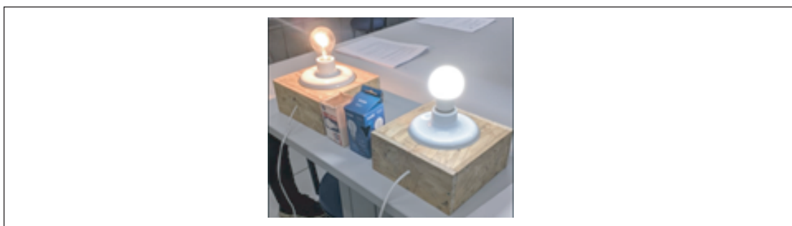
Figura 3 – Experimento com uma lâmpada incandescente de 40W e com uma lâmpada LED de 6W
